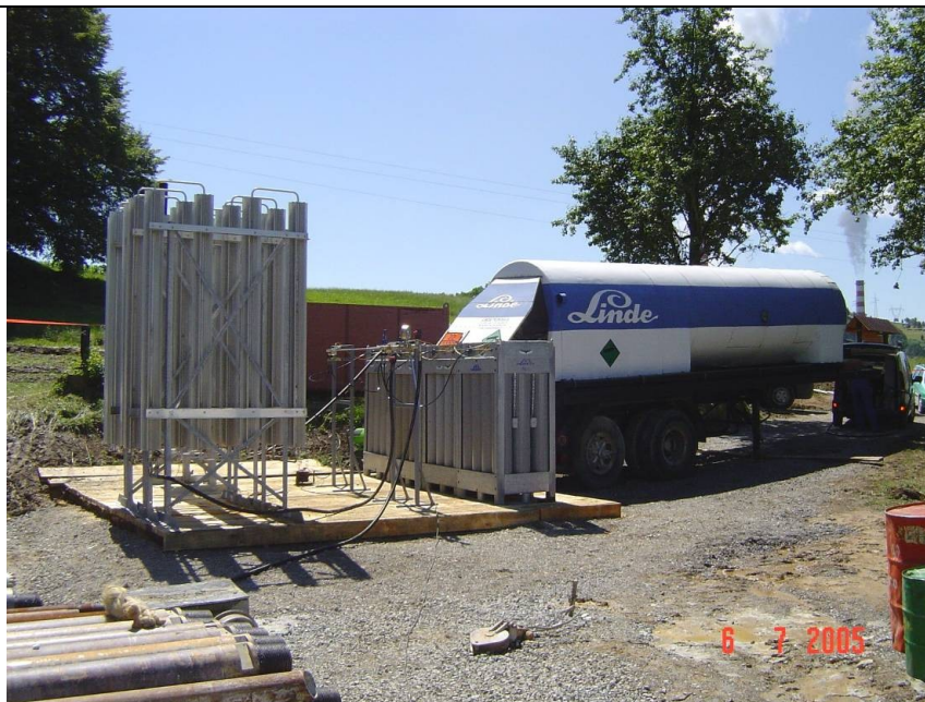
Figure 3: A trial injecting of carbon dioxide on the territory of mining area of Coalmine Velenje (Photo: Orešnik, 2005) (Source: Pregled dosedanjih raziskav na področju možnosti shranjevanja ogljikovega dioksida v Šaleški dolini, ERICo Velenje, Inštitut za ekološke raziskave, Velenje, junij 2006)
