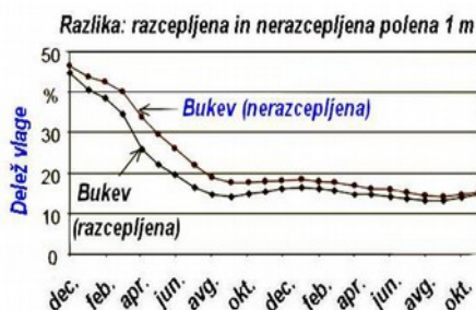
Slika 3; Zniževanje vlažnosti bukovih razcepljenih in nerazcepljenih drv v obdobju dveh let (Vir: TFZ Bayern)
